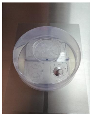
Afbeelding 11.8 Gaskap geplaatst over de gasspuitmond
